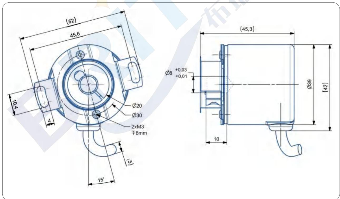
尺寸型号图 4: 抱箍 8mm IP54
