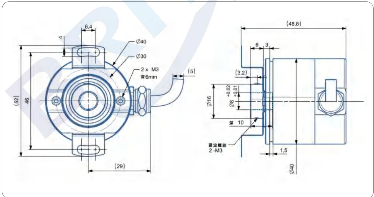
尺寸型号图 6: 8mm 盲孔 IP68/防爆
