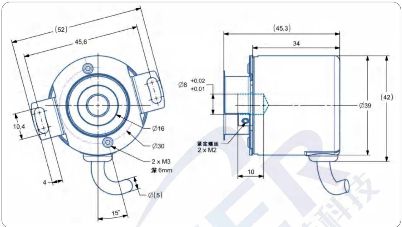
尺寸型号图 3: 盲孔 8mm IP54
